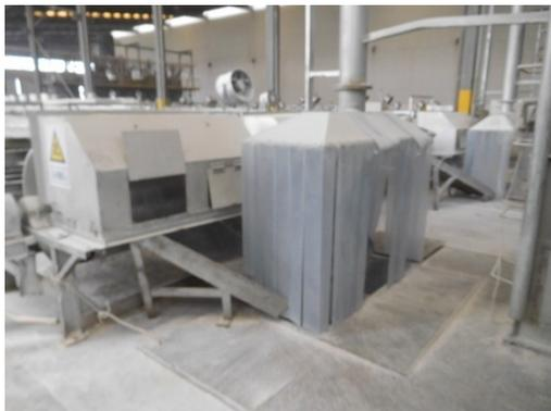
破碎机地下布置+室内布置
