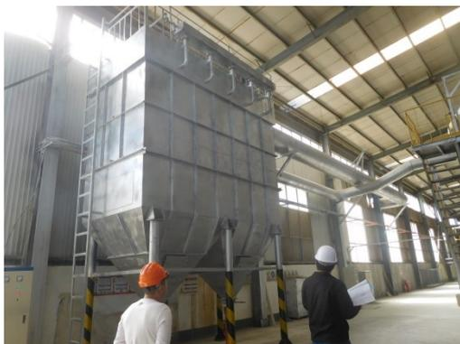
布袋除尘器（无铁硫酸铝生产线）
