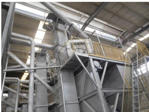
振动筛减振平台+室内布置
